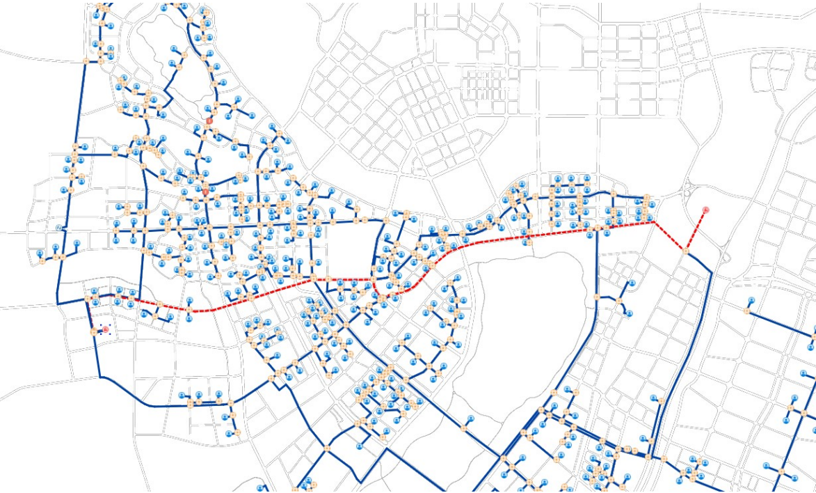
图7.10 工况二双热源供热联通管网示意图
